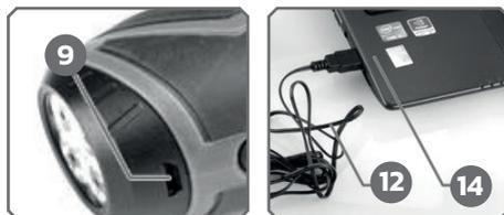
9. Tomada de ligação de carregamento USB 12. Cabo de carregamento USB 14. Dispositivos USB externos
