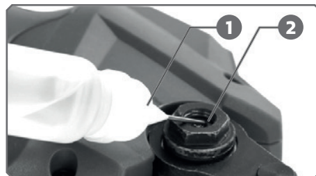
1. Garrafa de óleo da máquina 2. Orifício roscado
