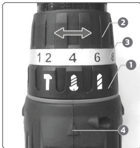
1. Anel de troca do modo de ação 2. Anel de ajuste 3. Graduação 4. Seta
